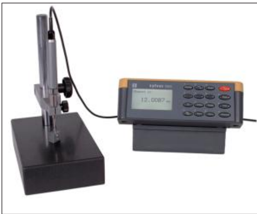
使用一个传感器通过四个通道测量四个尺寸
