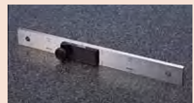
长量块的连接孔
