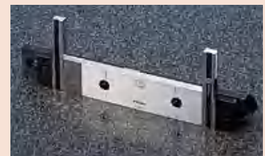
无孔的量规和各种量爪的结合示例
