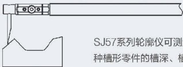
SJ57系列轮廓仪可测量各种槽形零件的槽深、槽宽及各种倒角的角度、宽度、深度、圆角的半径、位置等参
