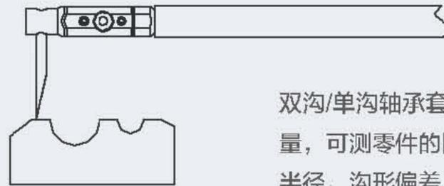
双沟/单沟轴承套圈的测量，可测零件的圆心位置、半径、沟形偏差、圆心距、圆边距等参数。
