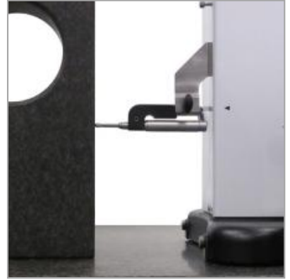
电子测头，测量垂直度
